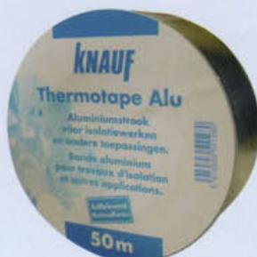
La condition sine qua non d'une isolation de toiture optimale est l'étanchéité du pare-vapeur. C'est la raison pour laquelle le raccordement impeccable entre les languettes d'agrafage est absolument indispensable. Afin de parfaire le travail des professionnels, Knauf a développé le Thermotape Alu, une bande en aluminium autocollante aux propriétés pare-vapeur pour le recouvrement des languettes d'agrafage.
